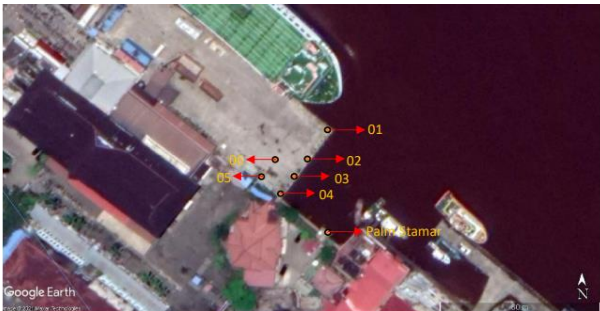
Gambar 2. Posisi titik-titik pengukuran waterpas terhadap palm pasang surut
